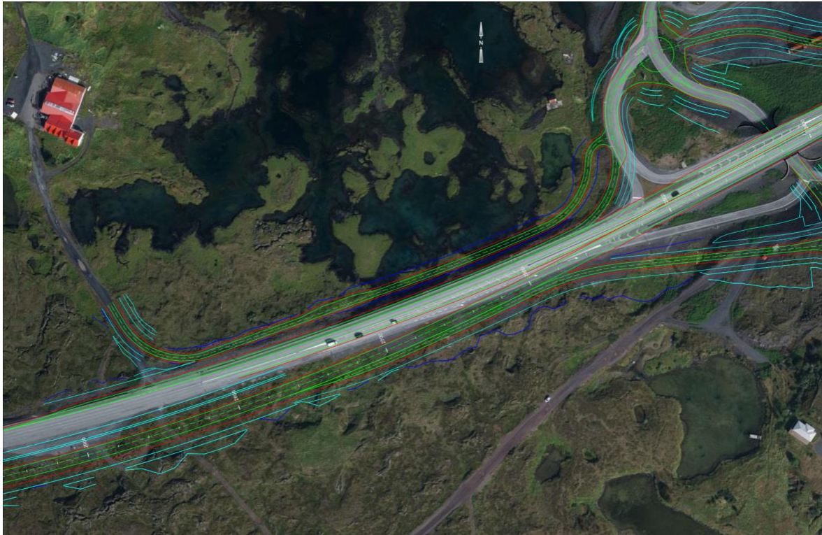
Mynd 4.8 Valkostur 1a – nærmynd af bráðabirgðavegtengingu að Straumi frá mislægum vegamótum við álver ISAL. Dökkblá lína sýnir fláafót fyllingar og hvernig hún kemur út í Straumstjarnir.
